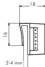
Brückenthalerungsmodule dienen zur Überbrückung bzw. zum verschraubbaren Abschluss einer Modulreihe. Somit können Leucht- und Brückenmodule in der Reihe nicht verschoben oder abgehoben werden.
