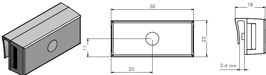
Abschlusshalterungsmodule haben keine Steckerseite und dienen zum Abschluss einer Modulreihe und können auch an dem Regalfach fixiert werden.
